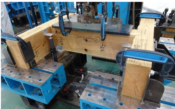
写真 横架材端接合部のせん断試験状況
