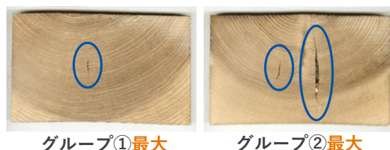
写真1 内部割れの状況
