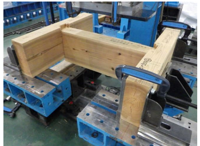
写真5 試験終了後の状況（試験体番号：4） 仕口部のめり込み及び割れ
