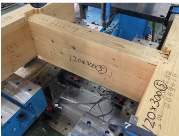
写真6 試験終了後の状況（試験体番号：5） 仕口部のめり込み及び割れ
