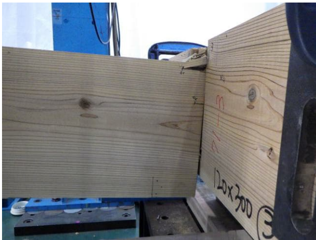
写真4 試験終了後の状況（試験体番号：3） 仕口部のめり込み及び割れ
