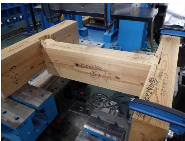
写真6 試験終了後の状況（試験体番号：5） 仕口部のめり込み、支持梁の割れ
