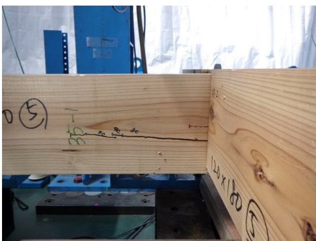
写真6 試験終了後の状況（試験体番号：5） 仕口部のめり込み，加力梁の割れ
