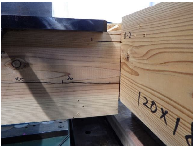
写真4 試験終了後の状況（試験体番号：3） 仕口部のめり込み，加力梁の割れ
