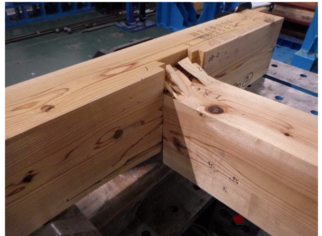
写真3 試験終了後の状況（試験体番号：2） 仕口部のめり込み，支持梁の割れ
