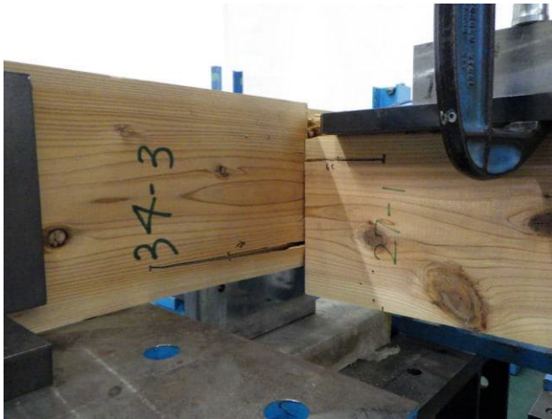
写真2 試験終了後の状況（試験体番号：1） 仕口部のめり込み，支持梁の割れ
