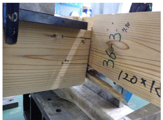
写真7 試験終了後の状況（試験体番号：6） 仕口部のめり込み，支持梁の割れ
