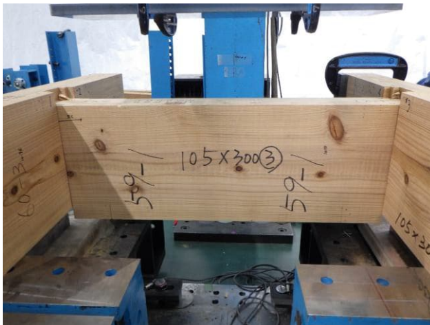
写真4 試験終了後の状況（試験体番号：3） 仕口部のめり込み及び割れ
