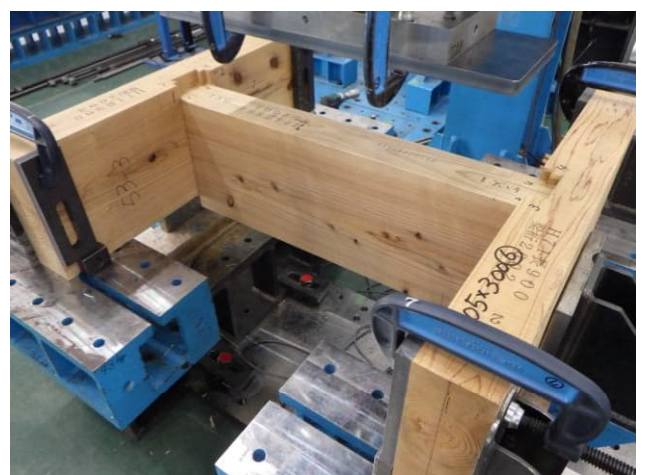
写真7 試験終了後の状況（試験体番号：6） 仕口部のめり込み及び割れ
