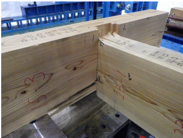
写真4 試験終了後の状況（試験体番号：3） 仕口部のめり込み，支持梁の割れ
