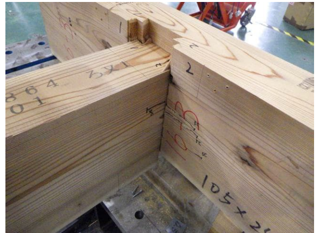
写真3 試験終了後の状況（試験体番号：2） 仕口部のめり込み及び割れ
