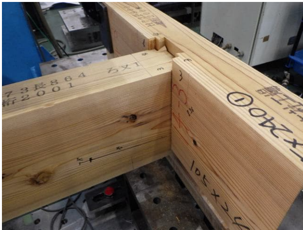
写真2 試験終了後の状況（試験体番号：1） 仕口部のめり込み及び割れ
