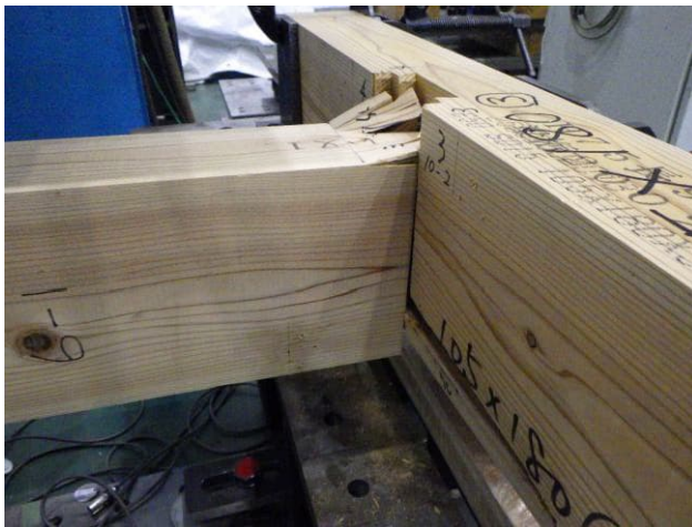
写真4 試験終了後の状況（試験体番号：3） 仕口部のめり込み、 加力梁及び支持梁の割れ
