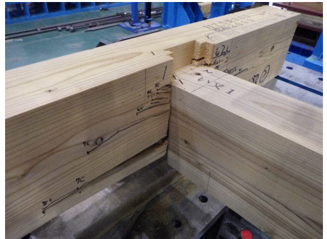
写真3 試験終了後の状況（試験体番号：2） 仕口部のめり込み、 加力梁及び支持梁の割れ
