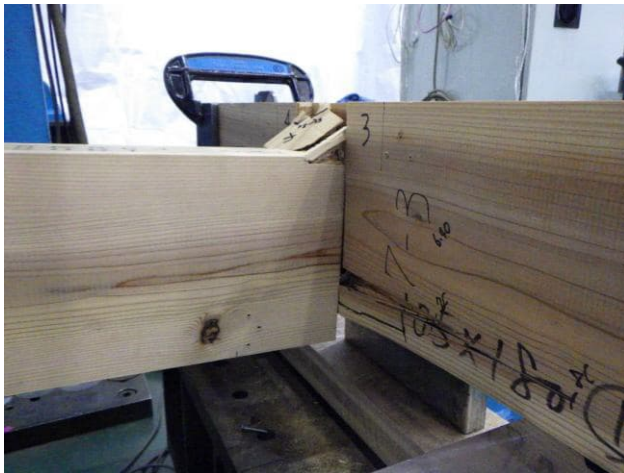
写真2 試験終了後の状況（試験体番号：1） 仕口部のめり込み、 加力梁及び支持梁の割れ
