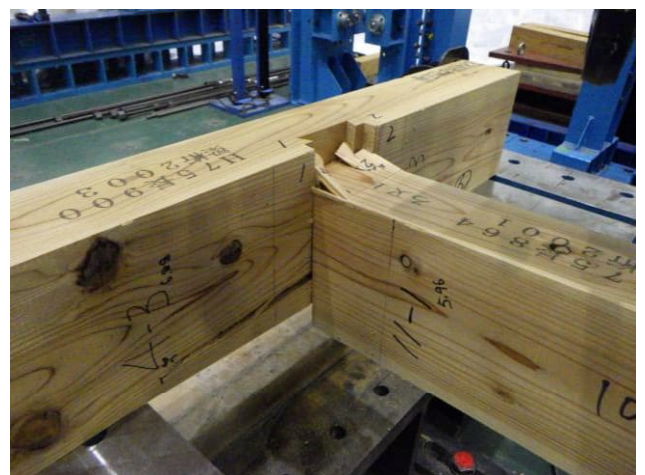
写真7 試験終了後の状況（試験体番号：6） 仕口部のめり込み、 加力梁及び支持梁の割れ
