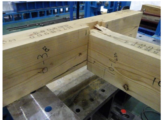
写真5 試験終了後の状況（試験体番号：4） 仕口部のめり込み、 加力梁及び支持梁の割れ
