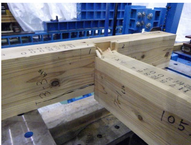
写真6 試験終了後の状況（試験体番号：5） 仕口部のめり込み、 加力梁及び支持梁の割れ
