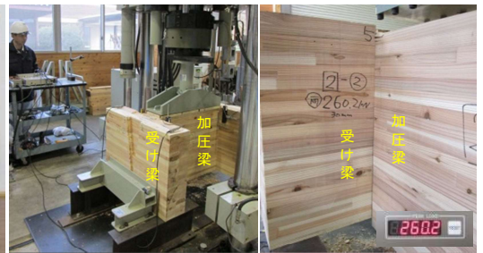
横架材端接合部のせん断試験状況
