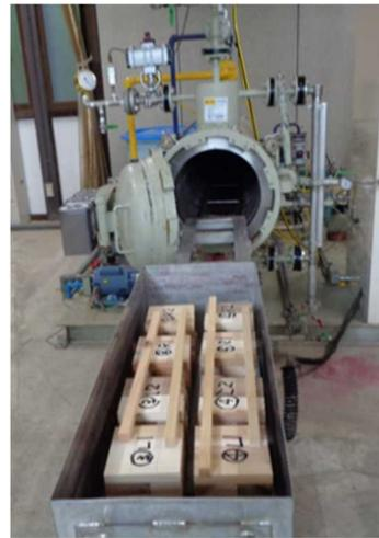
写真3 減圧加圧剥離試験
