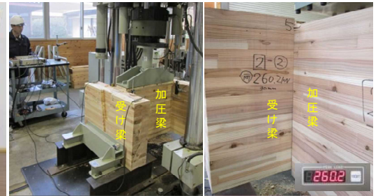
横架材端接合部のせん断試験状況
