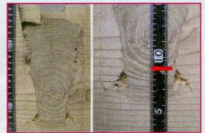
試験終了後、製材して縦断面を観察↑ 受け材が割裂していない 最大仕口耐力: 47.5 kN (上記試験体の場合)
