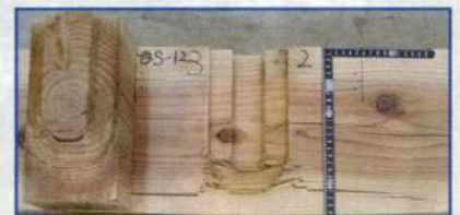
試験終了後 受け材が割裂している 最大仕口耐力: 16.6 kN (上記試験体の場合)
