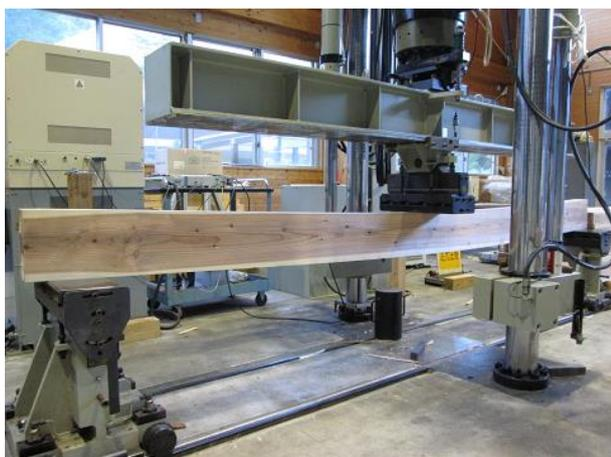
写真1 中央集中荷重（仕口加工無し）
