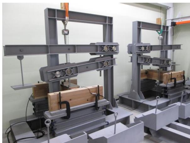
写真6 現在実施中の仕口せん断クリーブ試験
