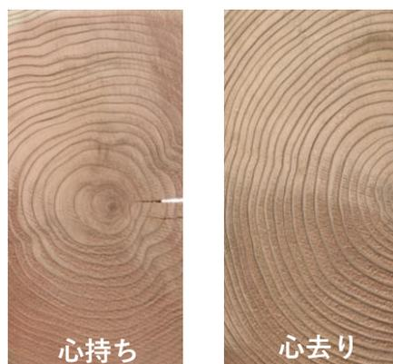
図2 心持ちおよび心去り平角材の断面
