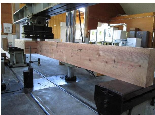
写真3 中央集中荷重（かん合試験体）
