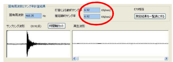
全木検認定モデル (SHIW-2016) によるスギ平角の強度測定
