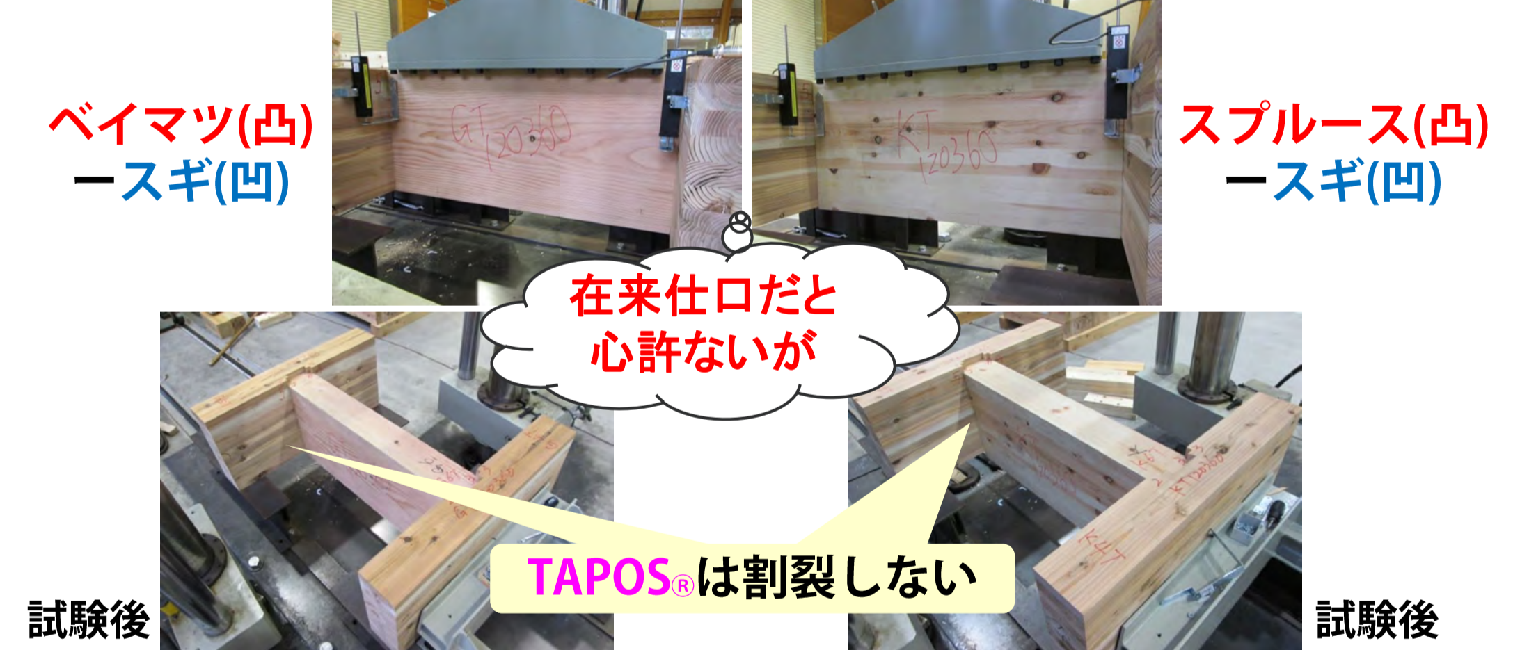
スギ材(受け梁)-外材(加圧梁)-スギ材(受け梁)試験
