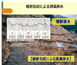
縦断勾配による誘導排水
