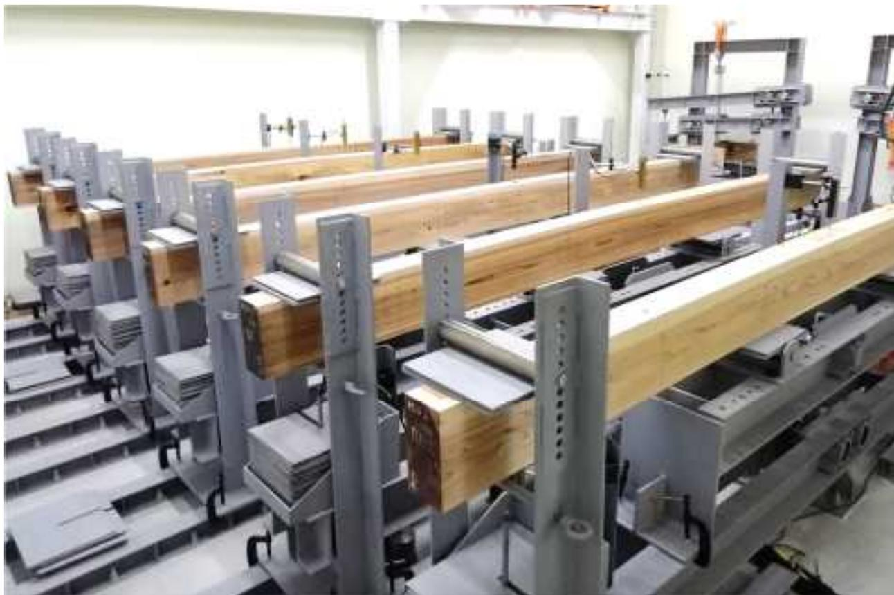
スギ心去り平角材の曲げクリープ試験
